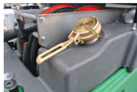
Il tappo di carico da 2". Filling quick cap 2".
