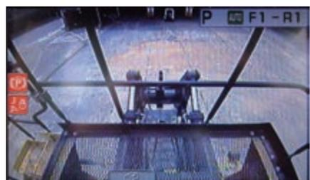
*Sistema di telecamera posteriore completamente integrata*
