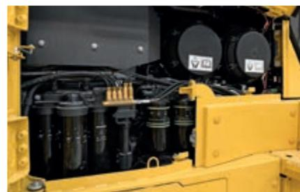
*Komatsu ha progettato il D375A-8 con punti di manutenzione centralizzati per facilitarne l'accessibilità durante le ispezioni e manutenzioni in modo da renderle facili e veloci.*
