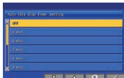
Spegnimento regolabile in caso di inattività arresta il motore dopo che è rimasto in folle per un intervallo di tempo prestabilito.
