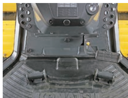
Pedale combinato deceleratore-freno
