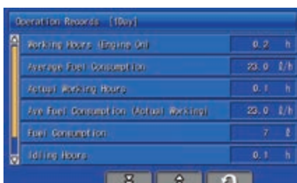
Vista veloce sulle informazioni funzionamento macchina
