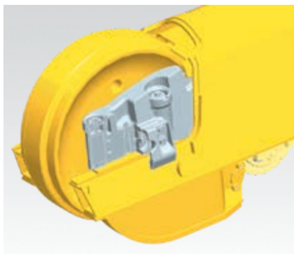
Supporto ruota folle a regolazione automatica
