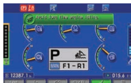
Indicatore Eco, guida Eco e indicatore livello carburante
