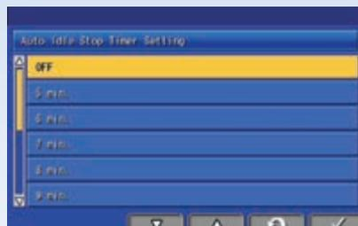
Lo spegnimento regolabile in caso di inattività arresta il motore dopo che è rimasto in folle per un intervallo di tempo prestabilito, mentre la nuova funzione di decelerazione automatica riduce automaticamente la velocità del motore quando le leve sono in folle per un tempo stabilito.
