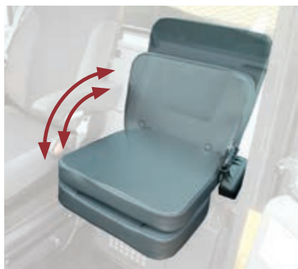
Il sedile passeggero a misura intera è dotato di cuscino pieghevole e poggiatesta per facilitare l'ingresso in cabina e l'accesso al filtro del condizionatore e al vano portaoggetti.
