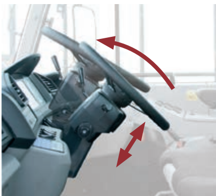
Disposizione del volante nella posizione più comoda
