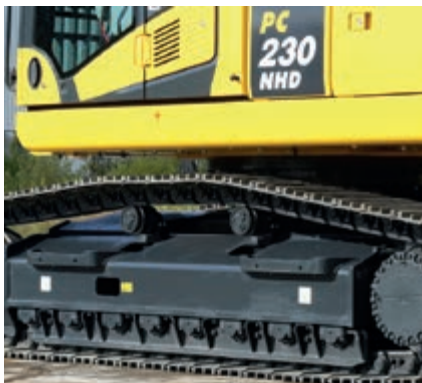
Sottocarro stretto per impieghi gravosi e struttura superiore stretta
