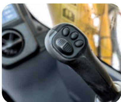
Comandi comodi, ergonomici e precisi: manipolatori con pulsante di comando proporzionale per gli accessori
