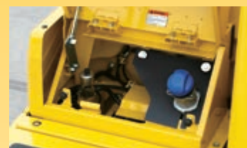
Per semplificare l'accesso, il serbatoio AdBlue® è installato vicino alla scala anteriore.
