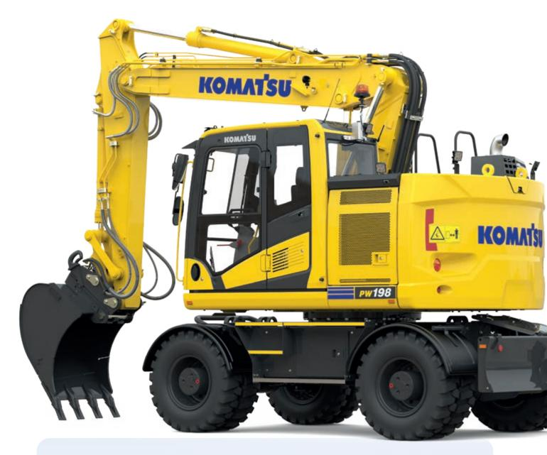
Peso operativo **17435 - 19355 kg**  Capacità benna max. 1,13 m<sup>3</sup>
