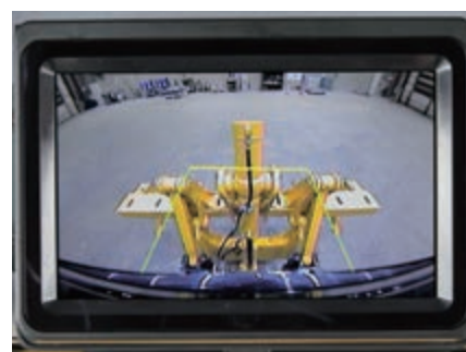
Sistema di telecamera posteriore completamente integrata
