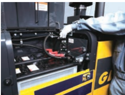
Interruttore generale impianto elettrico
