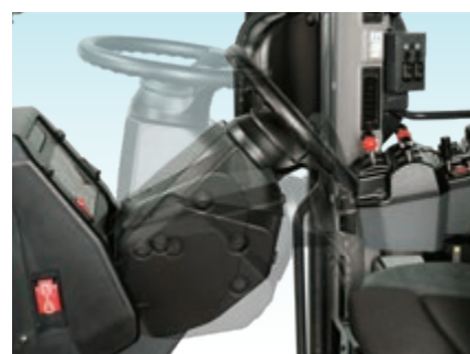
Disposizione del volante nella posizione più comoda
