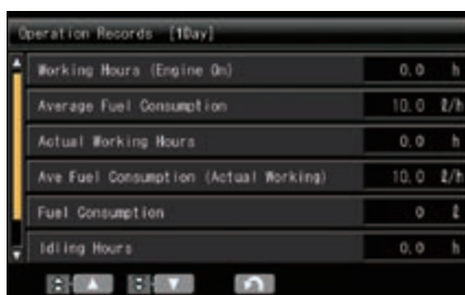
Un monitor multifunzione visualizza e gestisce una grande quantità di dati operativi e di manutenzione
