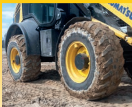
Bloccaggio differenziale manuale 100% anteriori/posteriori (optional)
