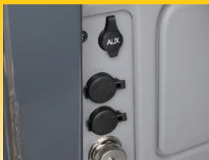
Ingresso ausiliario (presa MP3) e due porte di alimentazione a 12 volt
