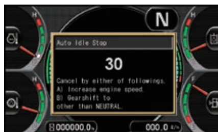
Lo spegnimento automatico regolabile in caso di inattività arresta il motore dopo che è rimasto in folle per un intervallo di tempo prestabilito
