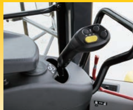
Sistema sterzante avanzato con joystick (Advanced Joystick Steering System)
