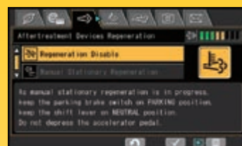
Schermata di rigenerazione del sistema post-trattamento per il KDPF
