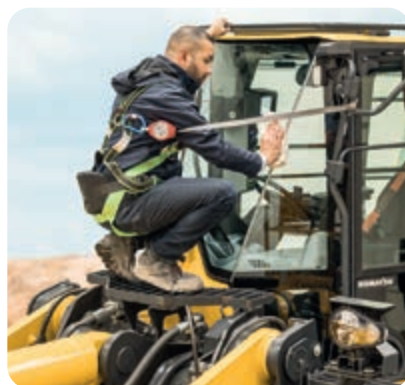
Gradino anteriore per la pulizia con accesso facile e sicuro al vetro anteriore
