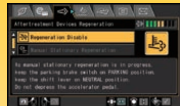
Schermata di rigenerazione del sistema post-trattamento per il KDPF
