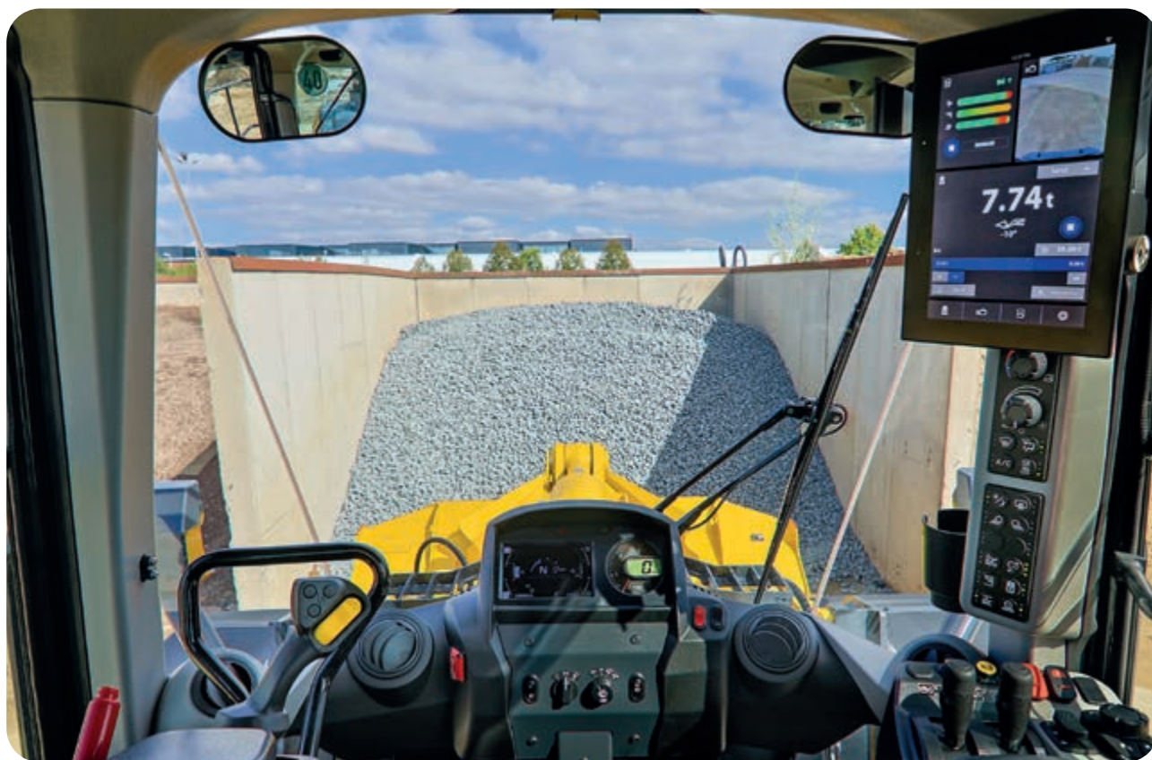
L'immagine mostra il sistema sterzante Advanced Joystick Steering System (AJSS) (optional) e SubMonitor (optional)
