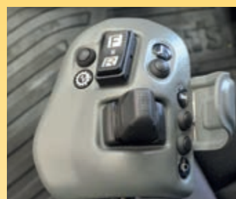
Leva corta di sterzo – Komatsu (K-SLS) (option)
