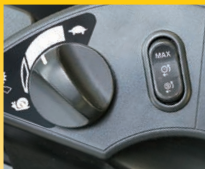
Quadrante di controllo con nuovo sistema di cambio velocità di traslazione a strisciamento (sinistra) e pulsante del sistema di controllo variabile della trazione (destra)
