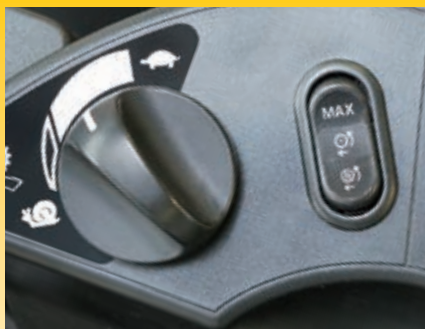
Quadrante di controllo con nuovo sistema di cambio velocità di traslazione a strisciamento (sinistra) e pulsante del sistema di controllo variabile della trazione (destra)
