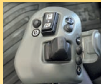
Leva corta di sterzo – Komatsu (K-SLS) (option)
