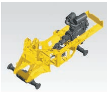
Solido telaio resistente alle sollecitazioni torsionali
