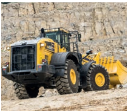
Solido telaio resistente alle sollecitazioni torsionali
